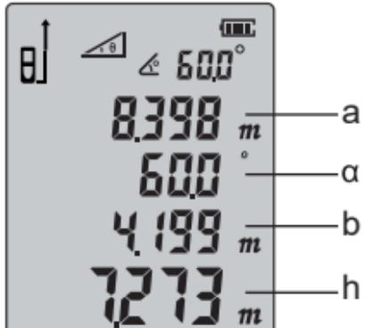
2》 测量直角三角形两直角边，间接测量斜边长度
